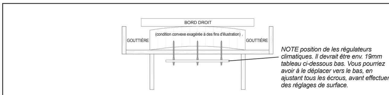
Pour corriger un terrain concave, desserrez l'écrou sous la barre de métal et serrez lentement l'écrou au-dessus de la barre métallique vers le bas contre la barre afin de pousser le centre de la surface de jeu vers le haut.
