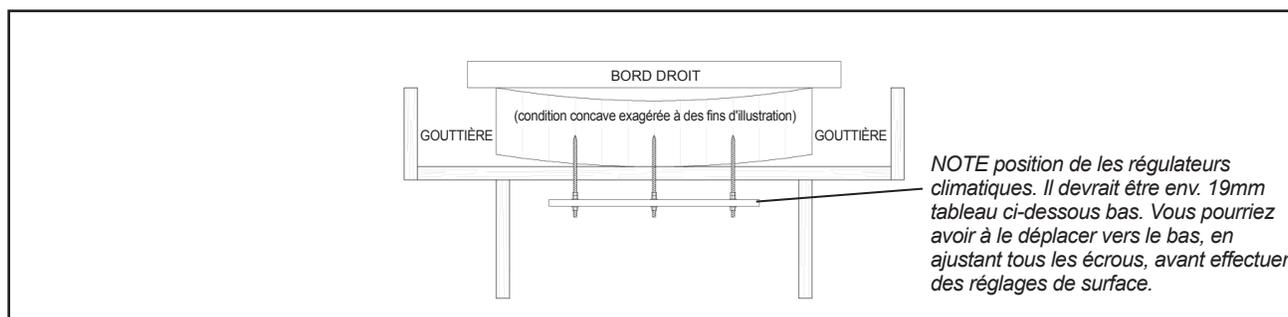
**Important : les écrous doivent être serrés lentement d'un  $\frac{1}{4}$  de tour et de  $\frac{3}{4}$  de tour à la fois. Il peut prendre quelques jours pour le surface de jeu ne réagisse complètement. NE pas trop serrer, car ceci peut causer des dommages permanents aux régulateurs climatiques et à votre table.**
